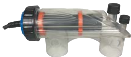
Cellule résistante à 6 bars de pression en coups de bélier
